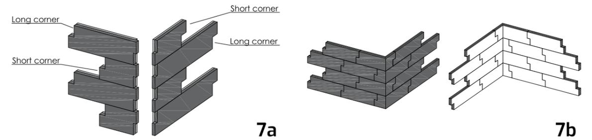
Para muros con esquinas: para evitar que se vean las juntas, usar una combinación de esquina larga y corta alternativamente entre las filas. Por ejemplo, primera fila larga-corta, segunda fila corta-larga, etc.
